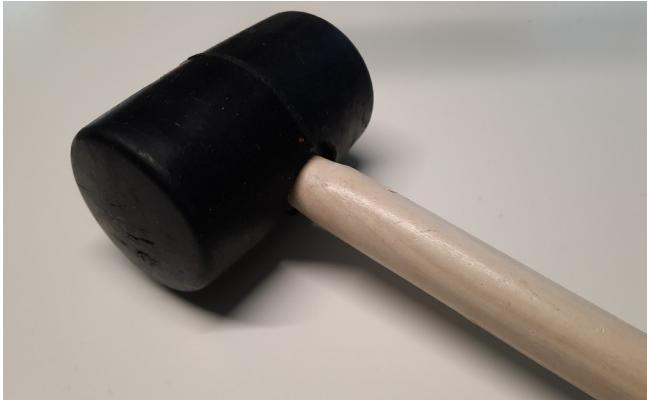
Gummihammer: Sehr zuverlässig bei geklebten Gehäusen - und richtet (meist) wenig Schaden an :-)
